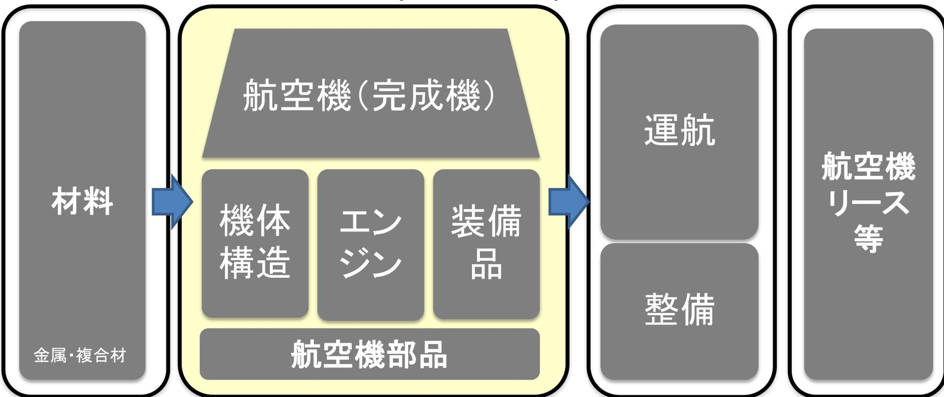
各専門メーカーで製造される、機体構造(胴体、主翼、尾翼など機体を構成する部位)、エンジン、装備品(航法・飛行制御システム、空調システム、電源システム、降着システムなど)を、完成機メーカーで組立てられ、航空機として完成し、運航会社へ納められます。
